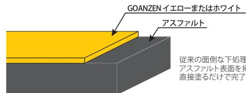
従来の面倒な下処理は不要です。アスファルト表面を掃除して直接塗るだけで完了します。
